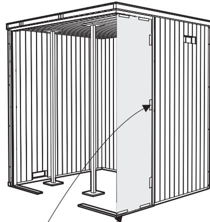
Klipp av 5cm-bitar av glaslisten för att tillfälligt stabilisera glaset under monteringen av resten av rummet.
