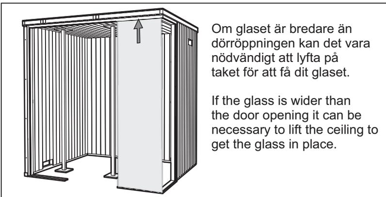
Om glaset är bredare än dörröppningen kan det vara nödvändigt att lyfta på taket för att få dit glaset.
