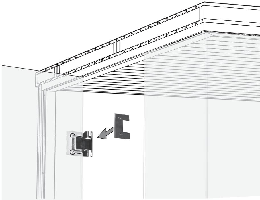
Lägg till packningar på gångjärnet och lyft
