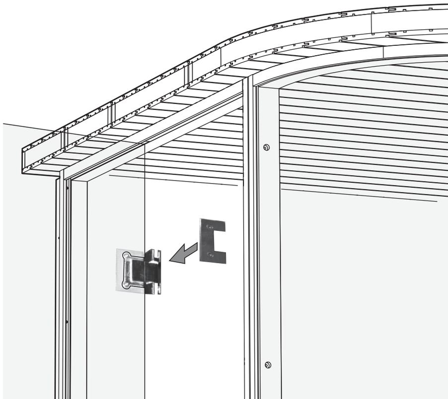
Lägg till packningar på gångjärnet och lyft
