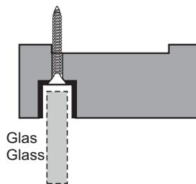
Se till att skruvens skalle ej sticker utanför aluminiumprofilen.
