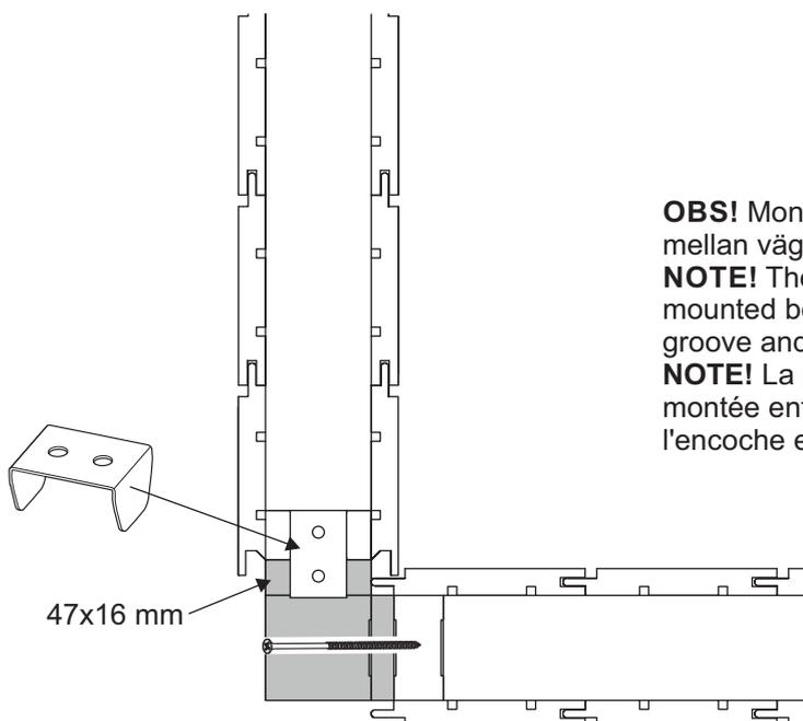
**OBS!** Monteringsblecket monteras mellan vägg med not och 47x16 regel
